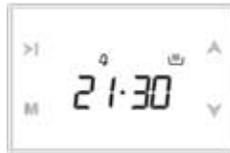
1. Wenn Sie **M** zwei mal berühren, wechseln Sie in den Alarm-Modus.
