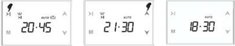
1. Dargestellt wird die derzeitige Endzeit des Back-Prozesses: Bei einer Tageszeit von 18:30 Uhr und einer Backzeit von 2 Stunden und 15 Minuten ergibt sich eine Endzeit von 20:45 Uhr.
