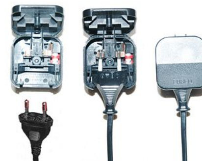
переходник на евровилку: пустой, со вставленной Евровилкой и закрытый
